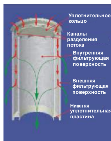
Рис. 2. Распределение потока в ДуоФЛО
